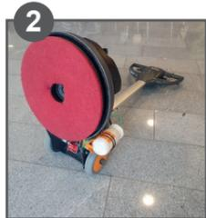
2 Rovesciare la macchina facendo toccare il manico al pavimento per montare trascinatore/pad o la spazzola.
