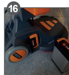
16 Sostituire le batterie se è necessario proseguire con il lavoro.
