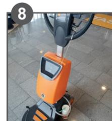
8 Inserire il tubo del serbatoio dell'acqua nella macchina e verificare che il cavo alimentazione della soluzione sia montato e funzionante.
