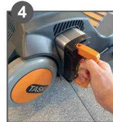
4 Inserire la batteria nel suo alloggiamento.
