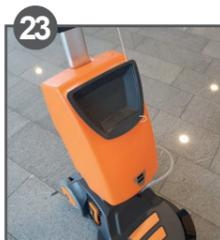
23 Se il serbatoio della soluzione è montato, svuotarlo e controllare/pulire la valvola come richiesto.
