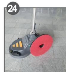
24 Non riporre le macchine con il pad o la spazzola montati.
